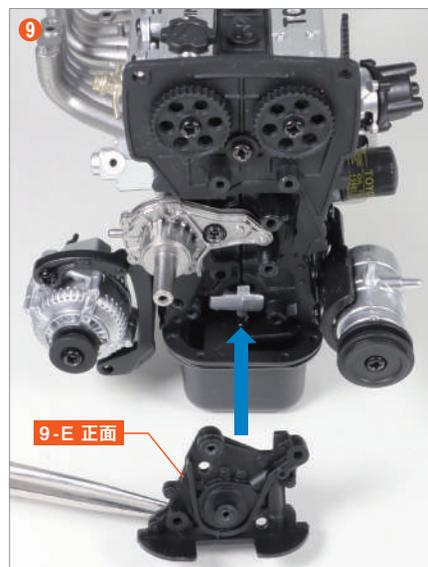
把油泵 9-E 的背面凹槽和突起部分分別對準 6-A 的螺絲孔突起部分和汽缸體 (R) 5-A 的洞孔，將其嵌入。
