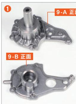
將水泵 (1) 9-A 的背面小突起部分和中央的螺絲孔與水泵 (2) 9-B 的洞孔和凹槽對齊嵌入。
