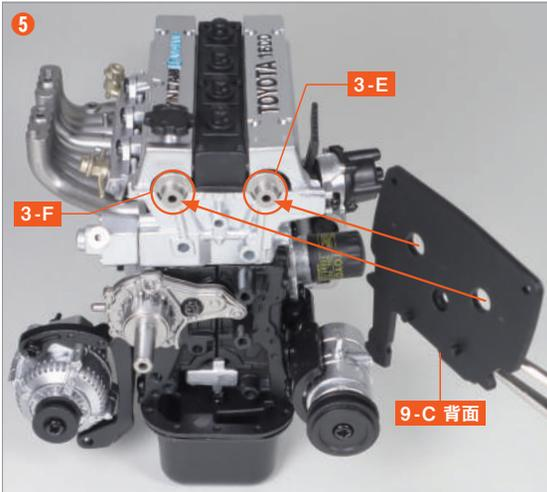
將正時皮帶外蓋 **9-C** 的背面 (平坦面) 與引擎的前面對齊, 將凸輪軸 (L) **3-E** 和凸輪軸 (R) **3-F** 的螺絲孔突起部分從 **9-C** 的兩個孔中出來。
